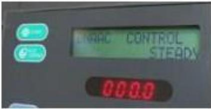
PT500A のアダプティブ制御は船体運動をモデルとして記憶し、船体特性に応じた操舵を行います。BNAAC はこれに加え風・波などが船体に与える外的影響をモデルとして記憶し、海象に応じたアダプティブ制御を行います。従来よりさらに小さい舵角で制御性を確保し省エネに寄与します。
