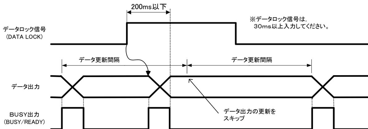
注) 出力タイミングを「定周期+データロック信号」に設定した場合、データロック信号が入力されている間の定周期によるデータ更新はスキップされます。
